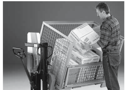
Nicht zu schwere und gut greifbare Last in einem praktischen, neigbaren Transportbehälter.
