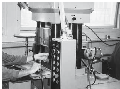
Bild 4: Einsetzen eines Werkstücks in eine Presse mit Fingerschutzvorrichtung und Schutzscheibensystem. Der Einsatz dieser Schutzvorrichtung ist ab dem 1.1.2012 verboten.
