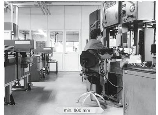
Bild 1: Für ausreichende Bewegungsfreiheit ist ein Raum von mindestens 800 mm erforderlich.
