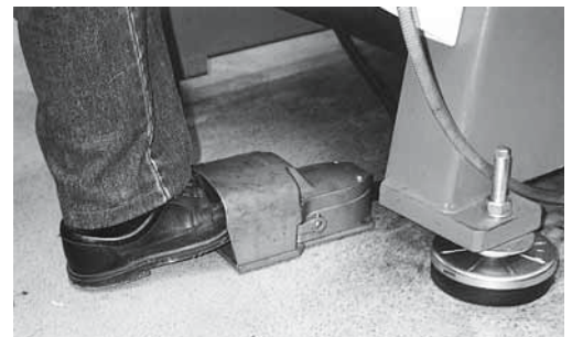
Bild 2: Der Fusschalter (Pedal) muss mit einer Schutzhaube ausgestattet sein.
