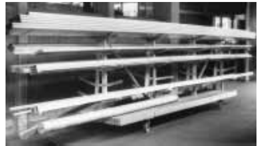
Bild 5: Horizontal gelagerte Profile auf einem Spezialwagen.
